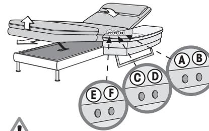
Das Longchair Comfort kann optional mit motorischer Herz-Kreislauf-Funktion (HK) ausgestattet sein. Die Bedienung erfolgt wahlweise über die 6 an der Sitzpolster-Außenseite angebrachten Sensortasten oder einen Handschalter.
