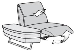
Motorkabel mit dem Netzteil verbinden und Netzkabel an eine Steckdose anschließen. Die Bedienung für Lehne und Fußteil erfolgt synchron über je eine Taste.
