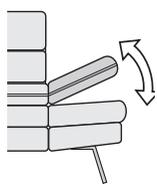
Die Armlehnen sind durch einen Rasterbeschlag im Winkel neigbar. 7 Stellungen sind möglich. Um die Armlehne wieder in ihre Ausgangsstellung zu bewegen muss diese zuerst bis über die obere (letzte) Rasterstellung gebracht werden.
