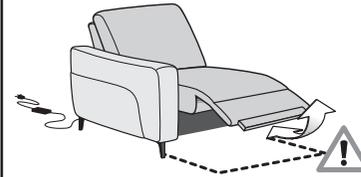
Motorkabel mit dem Netzteil verbinden und Netzkabel an eine Steckdose anschließen.
